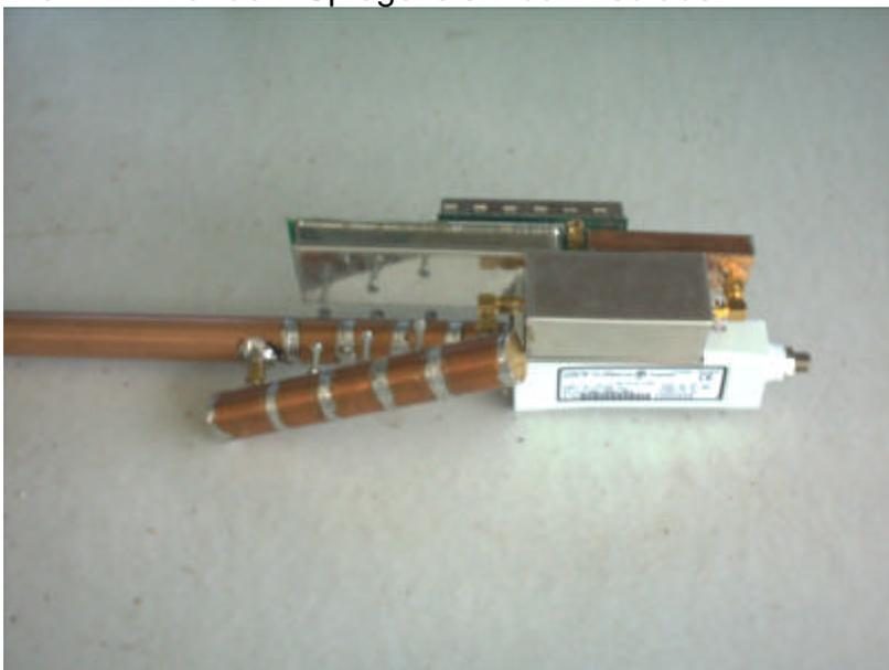
Links oben ist der Linksender mit direkt angeflanschten R100 Hochpass, dann Winkelstecker in die PA und dann über das Rohrfilter in das Spiegel-Feedrohr.
