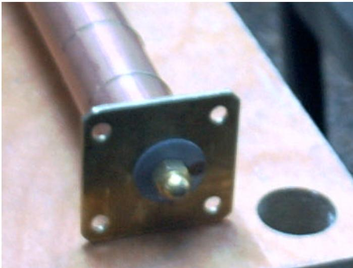
Man steckt nun alle Bleche in ihre Schlitze. Schiebt eine M5 Gewindestange durch das Ganze, und justiert das R120 Blendenblech so dass es mittig sitzt, und die „oben“ Markierung mit der Markierung des Rohres fluchtet.
