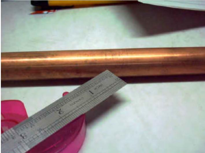
Auf dem Rohr muss eine Linie angerissen werden, an der die Schablone dann angelegt wird. Ich benutze dazu ein Stahl-Lineal und den ca. 12mm hohen Tesa-Band Abroller.
