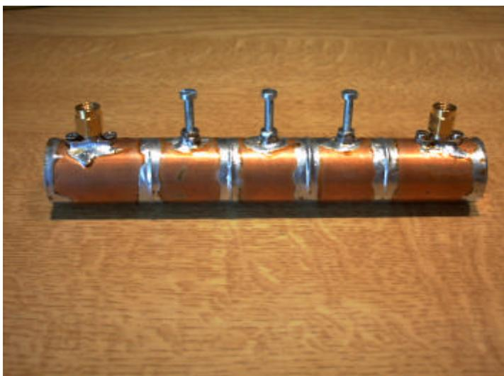
Das Bandfilter mit 2x SMA sieht nach dem Löten dann so aus:
