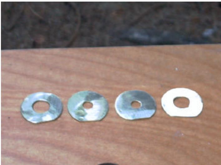
Dann braucht man die bearbeiteten Lochblenden. Außen jeweils die mit der großen Bohrung, innen die mit den kleinen Bohrungen.
