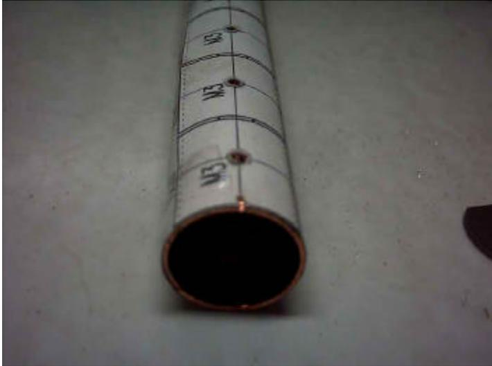
Dann noch eine Kerbe einsägen. Im vorliegenden Bild ist das die Seite des Filters an die später der R120 LNC Flansch angelötet wird. Auf dem Flaschblech kann man sich dann zur Ausrichtung Hilfslinien anreissen und das Rohr dann mittels des Schlitzes daran ausrichten.
