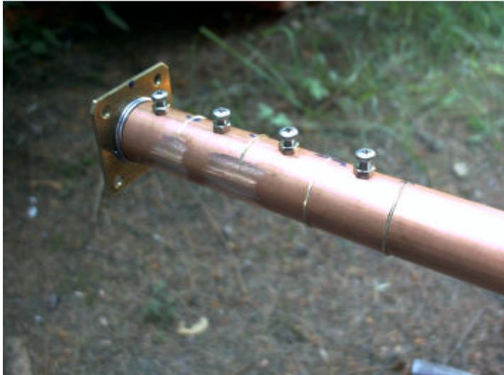
Dann wickelt man 2 Windungen Lötzinn um das Rohr nahe beim Flansch, und spannt das Rohr mit dem Flansch nach unten ein. Ein Heißluftfön oder eine kleine Flamme erledigt dann den Rest. (ebenfalls von unten)
