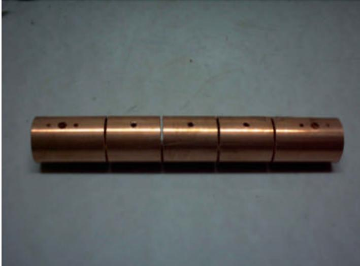
So sieht ein fertig gesägtes Rohr von oben aus. Hier ist es nicht das Spiegel Feedrohr, sondern ein Bandpassfilter mit 2x SMA Buchsen, der bei H/H Betrieb im TX Pfad hinter der PA liegt.
