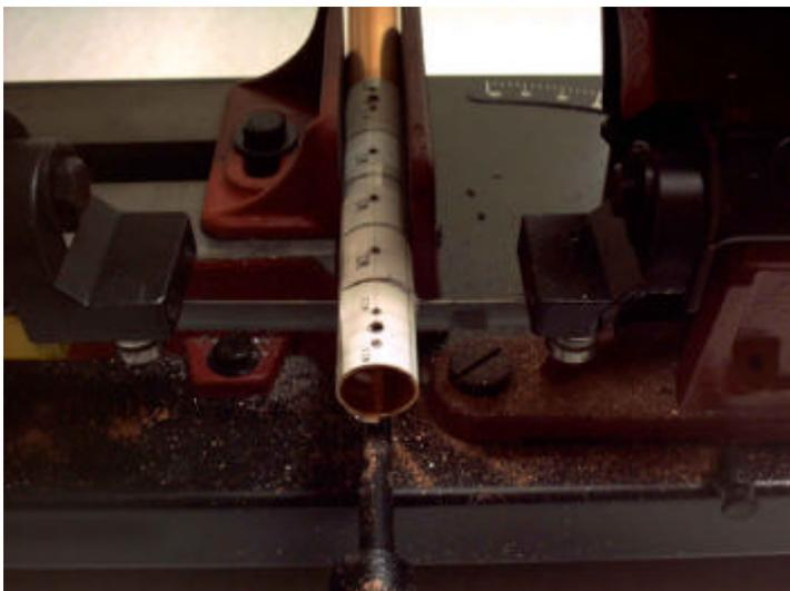
Ganz „easy“ geht's natürlich mit einer Metall Bandsäge. In diesem Fall braucht man aber immer ein Stück Rest-Rohr zum Einspannen. Bei der Hand-Säge erleichtert dieses „Griffstück“ das Sägen allerdings auch.
