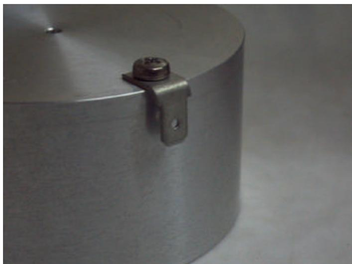
Die 4,8mm Flachstecker (KFZ) Zunächst 90 Grad umbiegen und dann mit M3x4 oder M3x5 V2A Schrauben befestigen.
