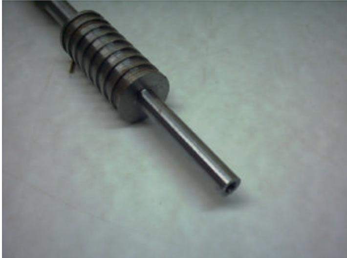
Um die ganzen Teile nun zentrisch zusammenzulöten gibt es sicherlich mehrere Möglichkeiten. Achim, DH2VA hat ein Drehteil angefertigt, welches als Montagehilfe dient. Die „Riffelung“ des dicken Teils dient zur thermischen „Entkopplung“.
