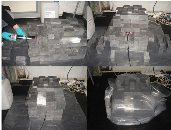
Abbildung 20: Messung der intrinsischen Gamma-Aktivität des NaI-Detektors.
