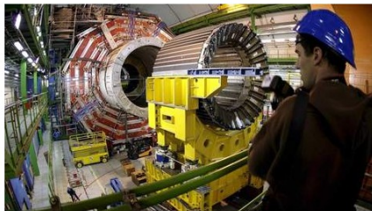
© EPA. Foto uit 2007 van de supergeleidende magneetkern van de deeltjesversneller van CERN in Genève.
